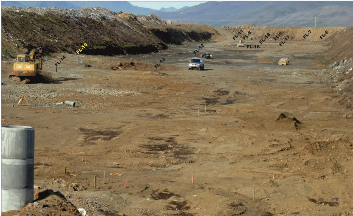
Mynd 6. Horft norður eftir urðunarrein #4 í júlí 2012. Borholurnar sem notaðar voru við lektarprófin eru merktar inn á myndina. Hola FL-14 er fyrir framan gröfuna og FL-19 nokkru fjær. Hola FL-13 er á klöppinni framan við jeppann og hola FL-12 ber í þak jeppans. Hola FL-15, sem er rétt utan við myndina sunnan við þrífótinn, er sýnd á mynd 14.
