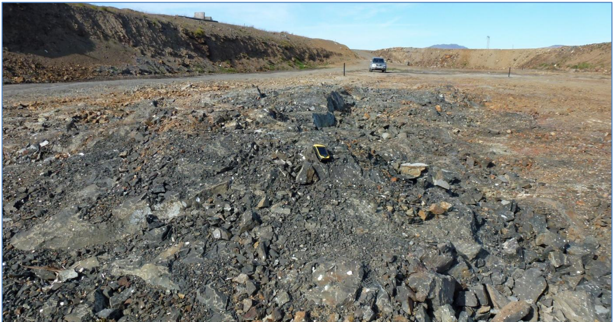
Mynd 22. Þóleiítbasaltið norðan til í urðunarrein #4. Allar sprungur og blöðrur eru fylltar útfellingum (geislasteinum).
